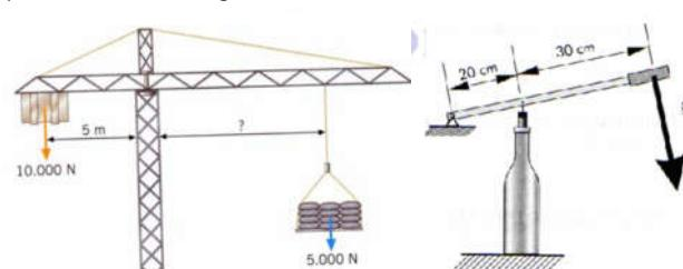
52.- Un mecanismo para poner tapones manualmente a las botellas de vino es como se muestra en el esquema de la figura. Si la fuerza necesaria para introducir un tapón es 50 N. ¿Qué fuerza es preciso ejercer sobre el mango?
