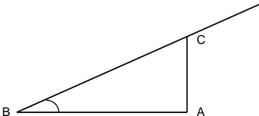
En el triángulo rectángulo de la figura medir sus lados, en mm, y hallar  $\sin B$ ,  $\cos B$  y  $\operatorname{tg} B$ . Medir a continuación B con el transportador de ángulos y comprobar con la calculadora lo obtenido antes (usar 4 decimales).
