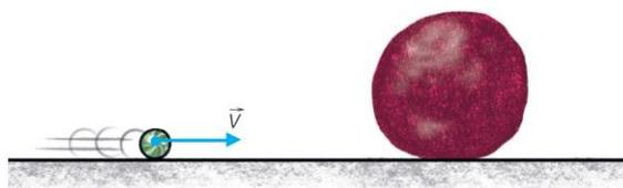
El momento lineal se conserva siempre (en ausencia de fuerzas exteriores), pero la energía cinética, no. Solo se conserva la energía cinética en choques elásticos entre cuerpos duros que no se deforman en el choque. Nos dice el enunciado que la canica queda incrustada. Para que esto sea posible la plastilina se deforma.
