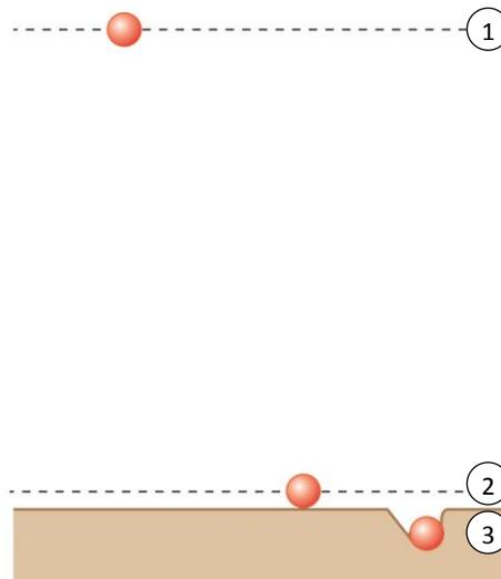
65. Un cuerpo de 5 kg de masa cae bajo la acción de la gravedad,  $g = 9,8 \text{ m/s}^2$ . Cuando se encuentra a 7 m del suelo posee una velocidad de 6 m/s.
