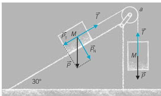
Siendo las dos masas iguales, el conjunto se moverá hacia la derecha, puesto que la componente del peso del bloque del plano inclinado en la dirección del movimiento  $P_T$  es necesariamente menor que el peso  $P$ .
