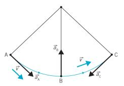
Al principio  $v_{\rm A}=0$ . Está parado, de modo que  $a_{\rm NA}=0$  (no puede tener aceleración normal si no se está moviendo). Sí tiene aceleración tangencial y está dirigida hacia B, pues en tal sentido va a aumentar el vector velocidad.
