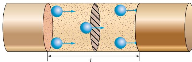
Una corriente eléctrica de intensidad 1 mA significa que pasa 1 mC cada segundo. En una milésima de segundo, pasa 1  $\mu\text{C}$ .
