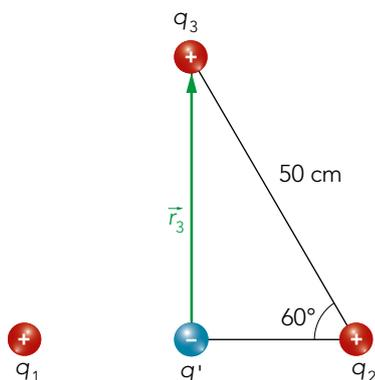
$$\text{sen } 60^\circ = \frac{r_3}{50} \rightarrow r_3 = 50 \cdot \text{sen } 60^\circ \approx 43,3 \text{ cm}$$
