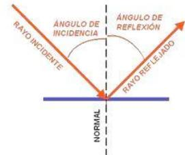
Se llama **ángulo de incidencia (i)** al ángulo que forma la dirección en que llega la onda con la normal a la superficie reflectora, y **ángulo de reflexión (r)** al que forma la normal con la dirección que sigue la perturbación después del choque.
