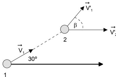
**Solución.** La dirección normal al choque es la dirección de  $\vec{V}'_2$ , luego conservación de la cantidad de movimiento en las direcciones  $\vec{N}$  y  $\vec{T}$  dan ( $m_1 = m_2$ )
