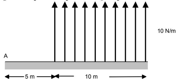
**Solución.** Como se explicó, el centro de la fuerza distribuida coincide con el centroide del rectángulo, esto es está ubicado a  $5 + 5 = 10 \text{ m}$  del punto A y la magnitud del torque será
