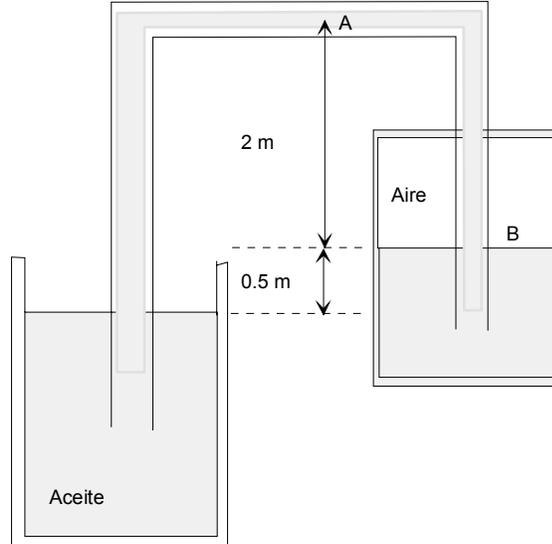
**Solución.** Al nivel del aceite de la izquierda tenemos actuando la presión atmosférica  $p_a = 1 \text{ atm} = 101\,325 \text{ Pa}$  y se tiene  $1 \text{ g cm}^{-3} = 1000 \text{ kg m}^{-3}$
