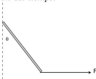
**Solución.** Sea  $x_{CM}$  e  $y_{CM}$  las coordenadas del centro de masas sobre el plano horizontal. Si la fuerza está aplicada en la dirección  $OX$  la coordenada  $y_{CM}$  no varía y puede tomarse cero. Entonces tenemos
