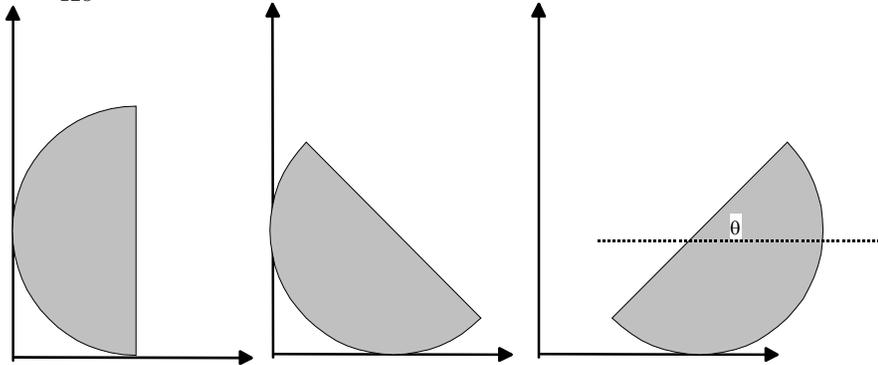
**Solución.** El centro de masa del cuerpo está a distancia  $3a/8$  del centro. Mientras no despegue, el cuerpo mantiene su centro fijo, y la única fuerza que realiza torque respecto a ese punto es el peso. Si en la segunda figura  $\theta$  es el ángulo que ha girado la línea que contiene el centro de masa, entonces
