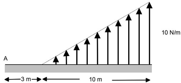
**Solución.** El "área" del triángulo es  $A = \frac{1}{2}(10 \times 10) = 50$  N, su centroide está a  $\frac{2}{3}10$  m del vértice izquierdo y luego el torque respecto al punto A tiene magnitud
