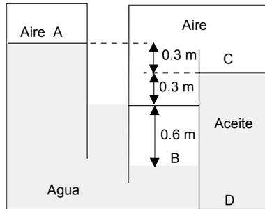
**Solución.** Supondremos que la presión atmosférica que actúa sobre la segunda columna de agua es  $p_a = 1 \text{ atm} = 101\,325 \text{ Pa}$ . Entonces
