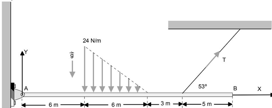
**Solución.** La fuerza distribuida tiene magnitud total  $\frac{1}{2}24 \times 6 = 72 \text{ N}$  y está aplicada a distancia  $x = 6 + 2 = 8 \text{ m}$  del punto A. Luego
