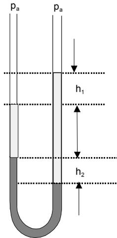
**Solución.** Sea  $\rho_a$  la densidad del agua y  $\rho_m$  la densidad del mercurio. La presión al nivel inferior del mercurio puede ser la misma y puede calcularse por las dos ramas obteniendo
