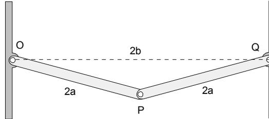
**Solución.** Por razones de simetría, la fuerza de interacción entre las dos barras en  $P$  sólo puede tener componente horizontal. (Nada distingue la barra derecha de la izquierda). Sea  $H_P$  esa reacción hacia la derecha sobre la barra  $OP$  y  $H_O$ ,  $V_O$  las componentes de la reacción en  $O$ .
