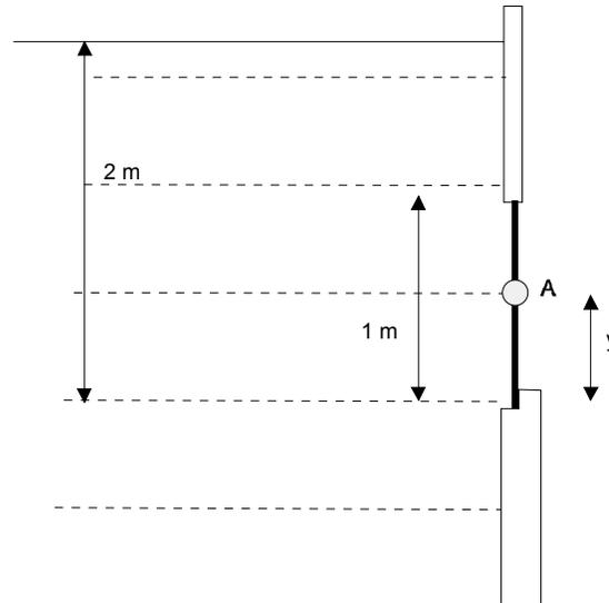
**Solución.** Si  $h$  indica una coordenada de posición medida desde la superficie del agua hacia abajo, entonces la presión en un punto ubicado a esa profundidad es
