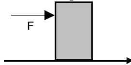
**Solución.** Sin fuerza aplicada, la reacción normal puede considerarse una fuerza distribuida homogéneamente en la base de modo que su resultante  $N$  tiene como punto de aplicación, el centro de la base. Sin embargo al aplicar la fuerza  $\vec{F}$  la distribución se "carga" más a la derecha. Sea entonces  $x$  el centro de esa fuerza, medido desde el centro de la base, tomado como origen  $O$ . De ese modo las ecuaciones de equilibrio son
