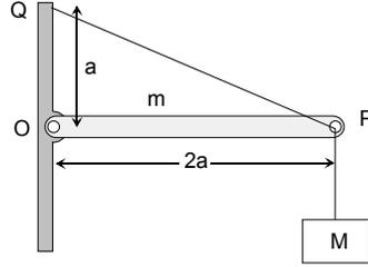
Determine la tensión en la cuerda  $QP$  y la reacción en  $O$ .
