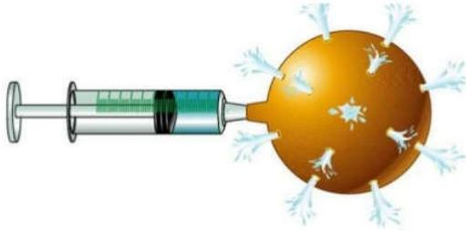
El principio de Pascal puede comprobarse utilizando una esfera hueca, perforada en diferentes lugares y provista de un émbolo. Al llenar la esfera con agua y ejercer presión sobre ella mediante el émbolo, se observa que el agua sale por todos los agujeros con la misma presión
