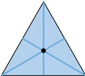
El ortocentro y el incentro coinciden en cualquier triángulo equilátero, ya que las bisectrices coinciden con las alturas.
