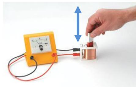
Al introducir y retirar alternativamente el imán en el hueco de la bobina variamos el campo magnético en el hueco de la bobina, por lo que el flujo magnético que atraviesa la bobina varía con el tiempo.
