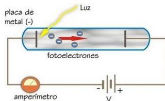
La Energía cinética y, por tanto, la velocidad de los electrones, se calcula experimentalmente frenando a los electrones mediante un campo eléctrico, hasta que pierdan toda su energía cinética. La diferencia de potencial necesaria se denomina potencial de frenado (diferencia de potencial mínima que hay que colocar en la pila para que los fotoelectrones que saltan queden frenados y no lleguen al otro extremo del tubo). Según esto:
