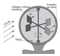
En dicho dispositivo existe un "molinete" metálico encerrado en el interior de una ampolla de vidrio a la que se ha hecho el vacío. En las cuatro aspas del molinete, una parte está pintada de negro mate, y la otra es una superficie metálica reflectante.
