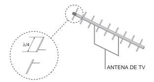
Los campos eléctricos oscilantes, generados por la recepción de la onda electromagnética, inducen corrientes a lo largo de las varillas de la antena que se traducen en una señal eléctrica que transporta, codificados, los datos de la imagen y el sonido.
