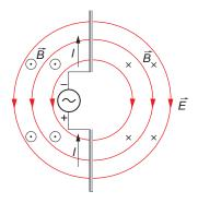
Al variar con el tiempo la corriente que circula por las varillas, las líneas de campo eléctrico se cierran, dando lugar a circuitos cerrados, al igual que las líneas de campo magnético, propagándose conjuntamente como una onda electromagnética.
